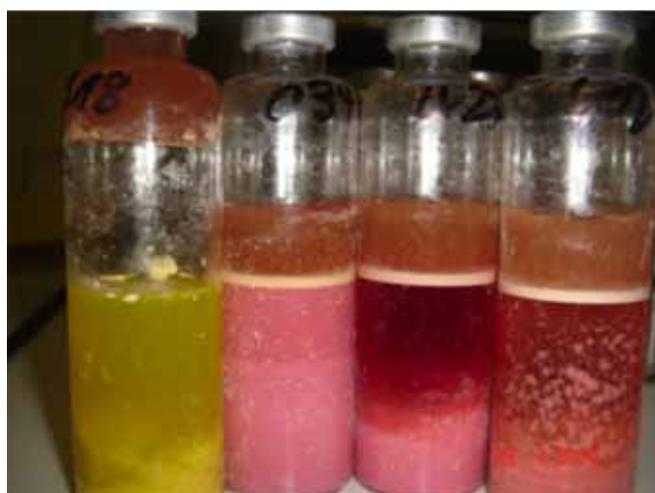
Figure 11: échantillons incubés du test MRCM - virage du rouge au jaune = positif
