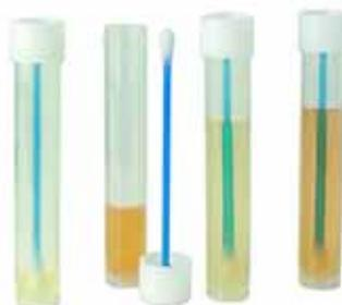
**Abbildung 9:** Fertigprodukte für das Betriebslabor. Bild links: Petrifilmplatte von 3M für coliforme Keime. Bild rechts: Abstrichupfer in Röhrchen mit verschiedenen Lösungen
