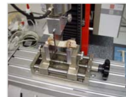
Messung der zum Brechen benötigten Kraft in Newton
