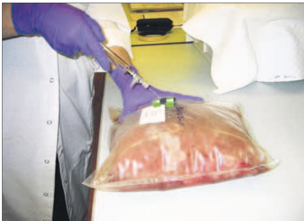
Prelievo di un campione di gas per l'analisi.
