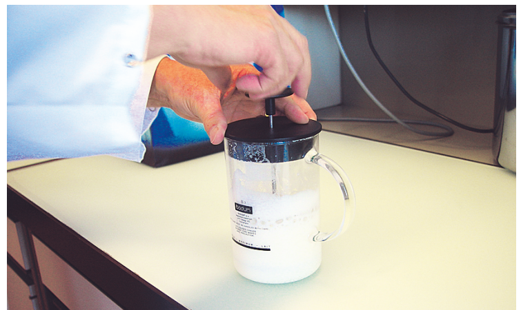
Abbildung 2: Zum Aufschäumen von Milch mittels Bodum 1446 (Cappuccino) wurden 250 g Milch auf 70°C erwärmt und während 60 s manuell aufgeschäumt.
