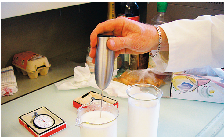
Abbildung 1: Zum Aufschäumen der Milch mittels Bodum Schiuma wurden 100 g Milch auf 70°C erwärmt und während 60 s aufgeschäumt.
