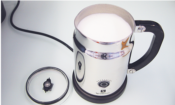
Abbildung 3: Zum Schäumen von Milch mittels Aeroccino von Nespresso wurden 100 g gekühlte Milch in den Behälter eingefüllt. Nach Knopfdruck wurde die Milch während ca. 65 s automatisch aufgeschäumt und dabei auf ca. 70°C erwärmt.
