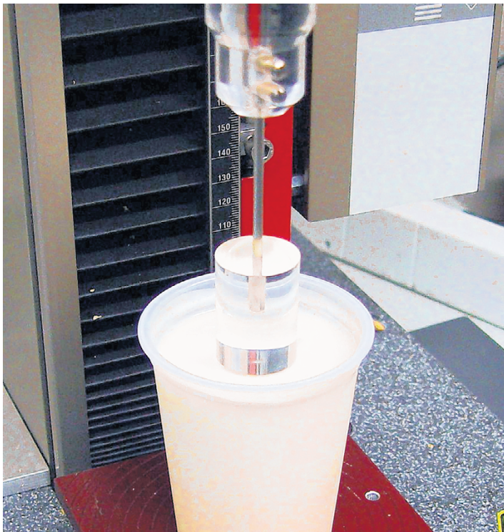
Die zwei verwendeten Methoden: Abb. 2a (links) die Zylinderpenetration, Abb. 2b (rechts) das Rheometer mit dem Flügelrührer. (Bilder: ALP).
