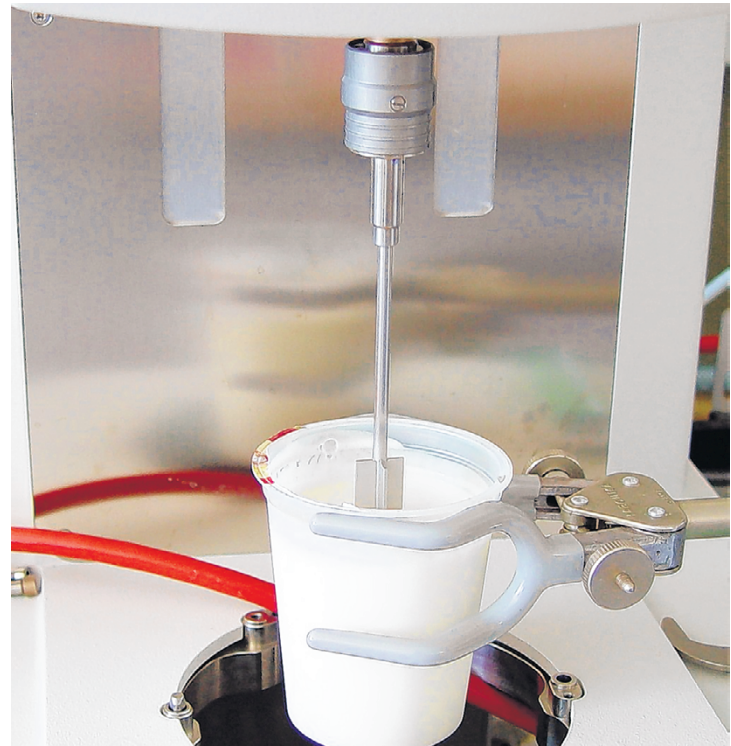
Die zwei verwendeten Methoden: Abb. 2a (links) die Zylinderpenetration, Abb. 2b (rechts) das Rheometer mit dem Flügelrührer. (Bilder: ALP).
