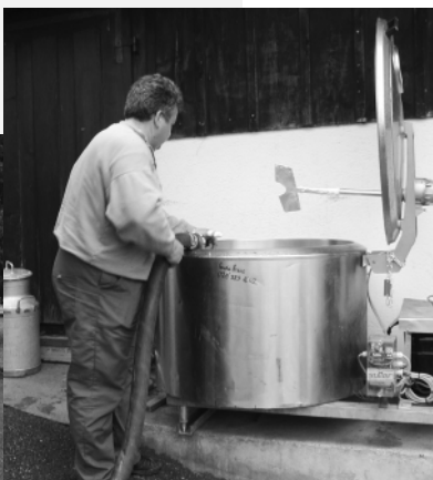
Bassin à crème avec refroidissement direct par évaporation
