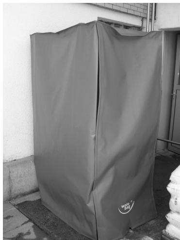
Abb. 5: Blachenabdeckung zur Beheizung mit Dampf bereit
