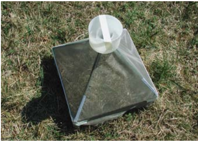
Abb. 8. Emergenzfalle à 50x50 cm; in der Kopfdose wurden Kleintiere gefangen (Foto: Sabine Rocker, ETH).
